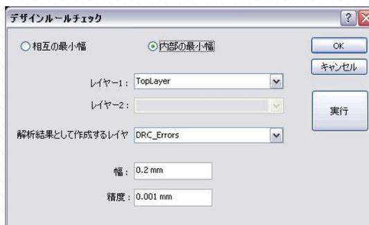
図の場合、パターンの中に『DRC\_Errors』レイヤーを使用してエラー箇所を示しています。
