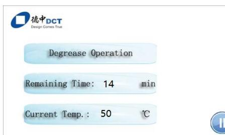
＞ 溶液の温度が設定温度に達したら、機能メニューに戻り、**Degrease** をタップします。
