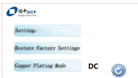
**Restore Factory Settings** をタップします。確認画面にて“YES”をタップすると設定は工場出荷時に戻ります。行わない場合は“NO”をタップします。
