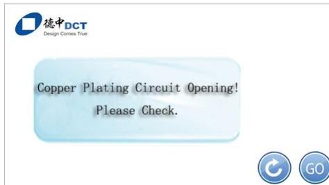
電流が上がらずゼロのまま、または設定した値より大きく差がある場合は、動作開始して約 15 秒間動作した後、左画面が表示され、停止します。ケーブルの接続を確認ください。
